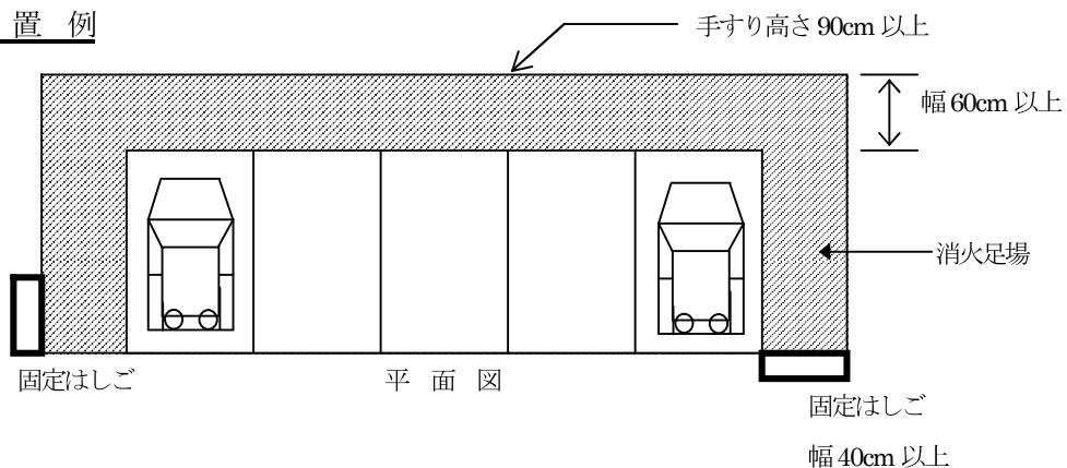
(イ) 昇降式の機械式駐車場の場合で、地下1層の場合は各スペースに、地上部分に設置した移動式特殊消火設備から有効に放射できる開口部を設けること。
