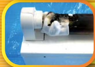
直管LEDランプと既設の照明器具の組み合わせが不適切な場合、
