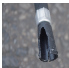
× ノズルの破損
